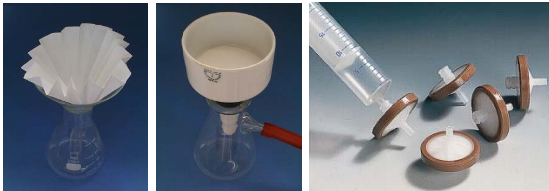
Abb. 6.3: Faltenfilter (links), Filter auf einer Nutsche (Mitte) und Spritzenfilter (rechts).
