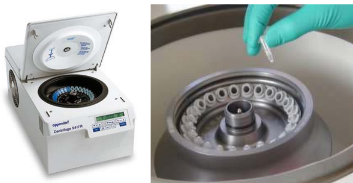
Abb. 6.4: Laborzentrifuge. Das Bild rechts zeigt, wie Probengefäße in die Zentri- fuge geladen werden.
